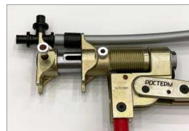
6. Вставьте фитинг в зажимной инструмент.
