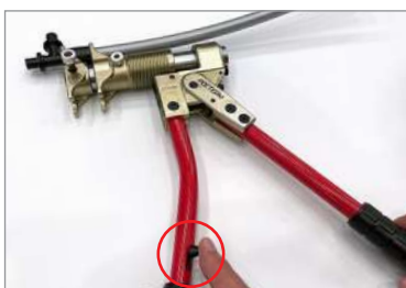
8. Потяните вниз блокиратор, чтобы разъединить рычаг и насадку на тиски, поднимите ручку тисков в верхнее положение, тиски автоматически разъединятся.
