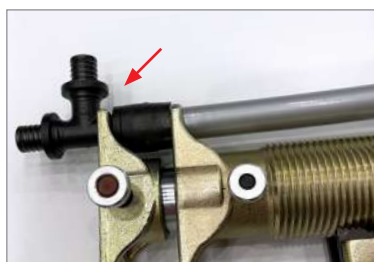
7. Проведите запрессовку до тех пор, пока гильза не соединится с кольцом фитинга полностью, рекомендуется избегать зазоров и несоосности соединения между фитингом и гильзой.
