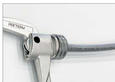
2. Вставьте наконечник насадки в трубу РЕ-Х.
