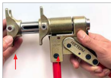
5. Переведите ручку тисков в верхнее положение, потяните вниз блокиратор, чтобы разъединить рычаг и насадку на тиски, вытащите осевые болты, установите необходимую насадку на тиски, зафиксируйте осевой болт и верните в исходное положение блокиратор.
