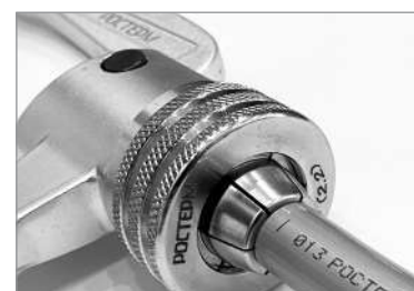
3. Проведите экспандирование трубы РЕ-Х в три этапа (30%, 70%, 100%), между этапами проворачивая расширяемую трубу на 30° вокруг своей оси.
